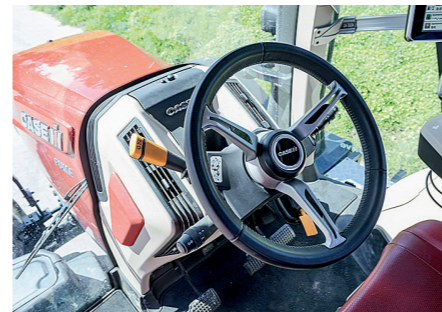
Patogų vairą su elektrohidrauliniu reverso svirtelė, turinčia parkavimo padėtį (t. y. padėtį su aktyvuotu stovėjimo stabdžiu), vertiname aukščiausiu balu. Jei dar ir posūkių svirtelė būtų sumontuota arčiau vairo, visiškai neturėtume jokių priekaištų
