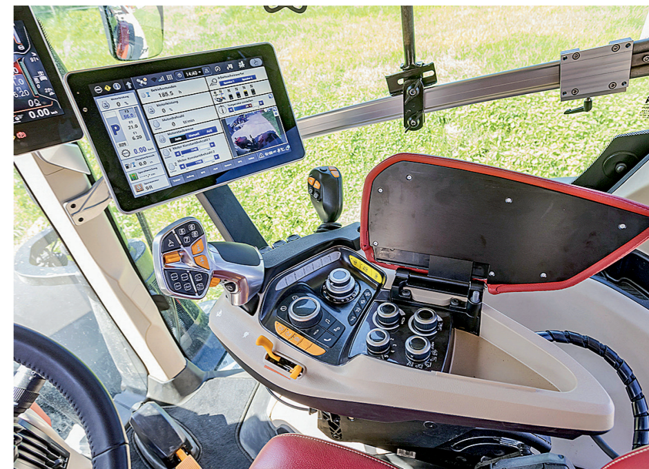
Prietaisų skydelis ant priekinio dešinės pusės statramsčio ir valdymo terminalas sėdynės porankio priekyje yra informatyvūs, rodmenys juose lengvai skaitymi. Daugiafunkcė svirtelė „Multicontroller“ turi daug mygtukų, ergonomiškai išdėstytų vienoje plokštumoje. Dėmesį detalėms rodo amortizatorius, neleidžiantis su trenksmu užsitrenkti porankio dangteliui
