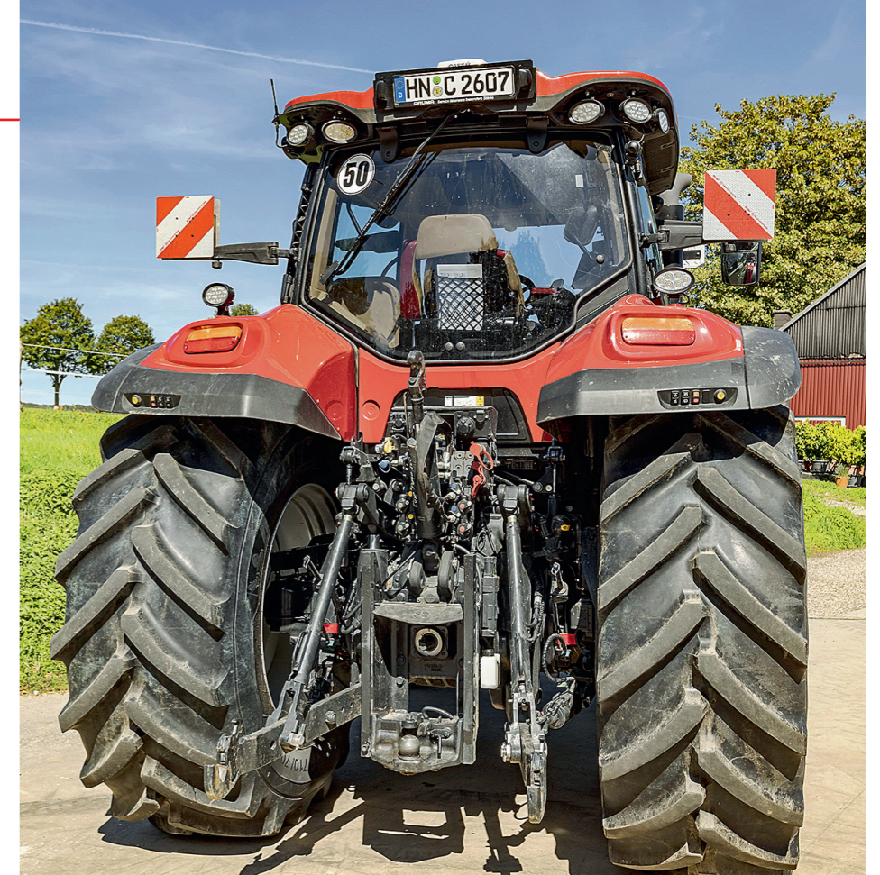
Už galinio elektrohidraulinio keltuvo charakteristikas bei alyvos kiekį išoriniams imtuvams rašome gerą įvertį. Jungčių išdėstymas taip pat racionalus: elektros ir pneumatinės jungtys įrengtos viršuje, HS skirstytuvo sekcijų movos – apačioje. Hidrauliniai apatinių trauklių stabilizatoriai naudingi, tačiau nebūtini
