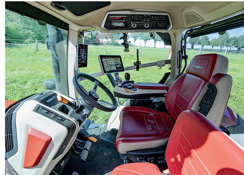
Puma kabina turi stebėtinai gerą garso izoliaciją – triukšmo lygis operatoriaus darbo vietoje tik 68,4 dB(A). Interjero apdailos medžiagos šįkart labai kokybiškos
