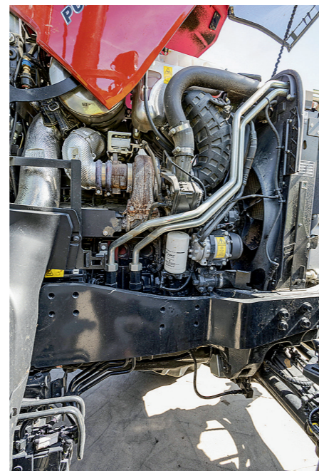
Variklio gaubto kairėje sumontuota vaizdo kamera yra geras dalykas, padidinantis aktyvųjį saugumą. Priekinis elektrohidraulinis keltuvus puikiai integruotas į liemens struktūrą, tačiau centrinė trauklė tik II kat., o jos laikiklis – visiškai nepraktiškas
